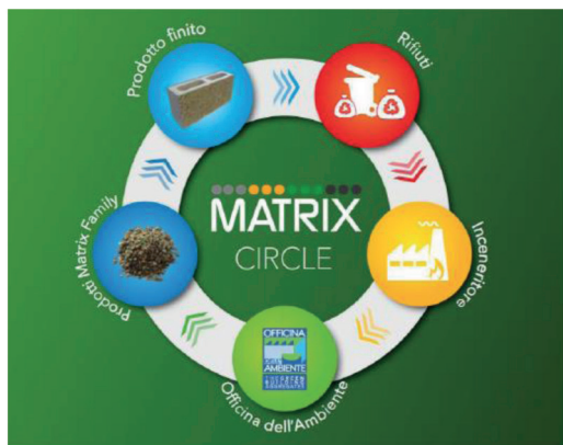
Fig. 2 – Il ciclo produttivo del Matrix di Officina dell’Ambiente SpA
